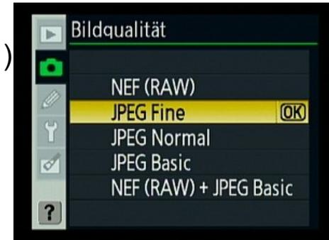
Während hochwertige Kameras die Bilder in einem Rohformat (RAW-Format) und/oder JPG speichern, werden die Bilder bei einfachen Kameras nur im JPG-Format gespeichert. JPG-Dateien werden dabei Kameraintern aufbereitet und werden mehr oder weniger komprimiert - die Bilder brauchen weniger Speicherplatz und können sofort betrachtet und verschickt werden.
